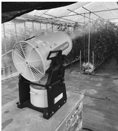
図1. 常温煙霧処理の様子 ※株式会社丸山製作所の常温煙霧機 （フレッシュハウサーLVM16）を使用
